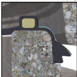
Szkic nr 1: Uszczelka samosmarująca z kompensatorem naprężeń
